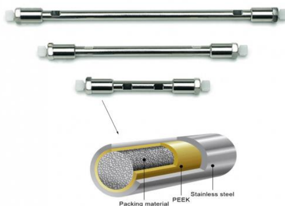
شکل ۱۵. نمای بیرونی و درونی ستون دستگاه HPLC.
